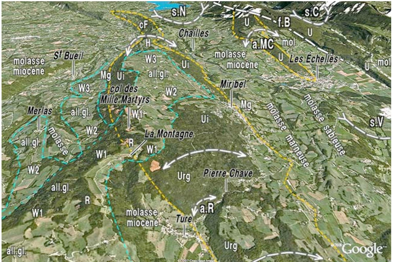
**a.R** : anticlinal du Ratz (charnière occidentale) ; **s.N** = synclinal de Novalaise ; **a.MC** = anticlinal du Mont du Chat ; **f.B** = faille du mont Beauvoir ; **s.C** = synclinal de Couz ; **s.V** = synclinal de Voreppe. Les tirets jaunes soulignent la surface de transgression du Miocène (recouverte par les calcaires gréseux burdigaliens) ; les tirets bleus cernent les principales plages d'alluvions glaciaires qui coiffent la montagne. (d'après une image extraite de "google-earth")
